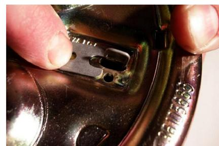
4)...bei gleichzeitigem Wegschieben des Gegenbleches auf der Rückseite der Bremstrommel. Bowdenzug aushängen und die alten Bremsbacken entnehmen.
