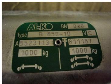
Den **Bremstyp**, eingeprägt im Bremsträgerblech (Rückseite der Bremstrommel)
