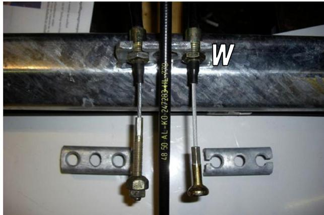
Verschiedene Ausführungen der Verbindung zur Bremswaage. Links die ältere Ausführung mit Gewinde. Hier müssen die Muttern zum einhängen gelöst und danach genau eingestellt werden. Rechts die neuere Ausführung mit verpressten Anschluss. Hier kann der Zug einfach durch die Schlitz an der Bremswaage gesteckt werden. Der Aufdruck an der Hülle des Bowdenzuges ( Bildmitte ) zeigt die Hüllenslänge, zum Beispiel HL770 ( bitte bei Bestellung angeben )
