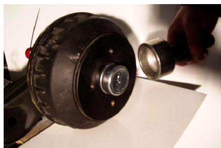
2) Auf die Fettkappe stecken und diese durch hin- und herwackeln demontieren. Lösen Sie dann die Mutter mit einer Stecknuss SW 32 oder 36.
